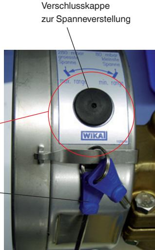
1. Die Spanneverstellung ist am Gehäuseumfang bei 4 Uhr durch Abnehmen der Verschlusskappe zugänglich.
