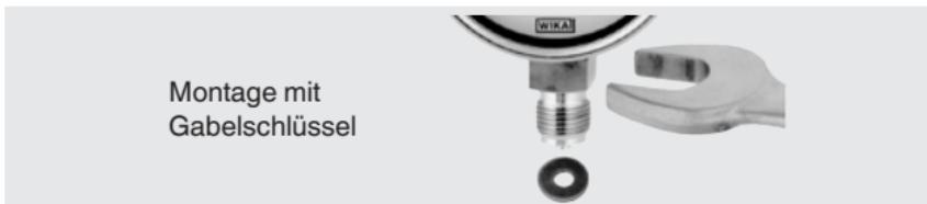
Zur Abdichtung der Druckmessgeräteanschlüsse mit zylindrischen Gewinde an der Dichtfläche ① sind Flachdichtungen, Dichtlinsen oder WIKA-Profildichtungen einzusetzen. Bei kegeligen Gewinde (z. B. NPT-Gewinde) erfolgt die Abdichtung im Gewinde ②, mit zusätzlichen Dichtwerkstoffen, wie z.B. PTFE-Band (EN 837-2).
