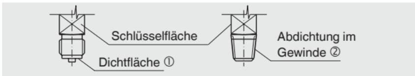
Das Anzugsmoment ist von der eingesetzten Dichtung abhängig. Um das Messgerät in die Stellung zu bringen, in der es sich am besten ablesen lässt, ist ein Anschluss mit Spannmuffe oder Überwurfmutter zu empfehlen. Sofern ein Druckmessgerät eine Ausblasvorrichtung
