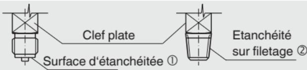
Le couple de serrage dépend du joint utilisé. Afin de positionner l'appareil de mesure de façon à ce qu'il soit facilement lisible, il est recommandé d'utiliser un manchon de serrage ou un écrou-chapeau. Au cas où un manomètre est équipé d'une paroi arrière éjectable,
