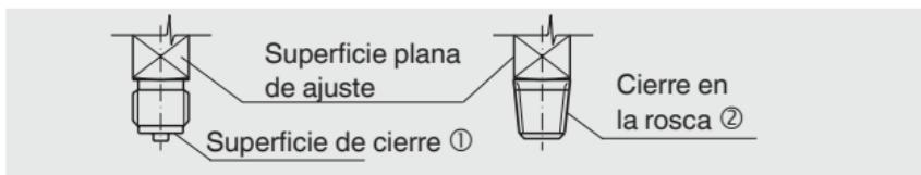
El momento de arranque depende del tipo de cierre utilizado. Para poner el manómetro en la posición que proporcionará la mejor lectura, se recomienda una conexión con un manguito tensor o tuerca tapón. Si un manómetro está dotado de un dispositivo de ventilación es
