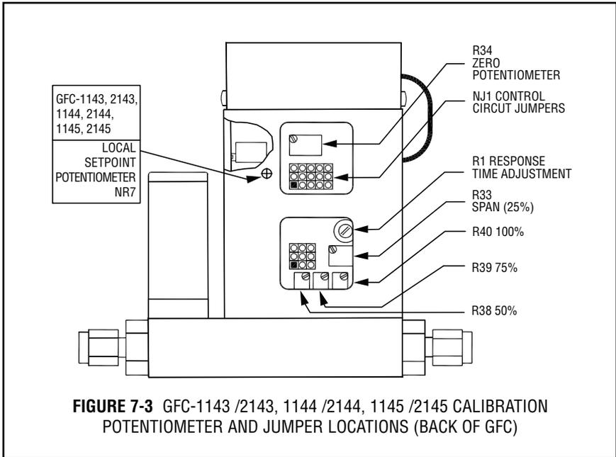
**FIGURE 7-3 GFC-1143 /2143, 1144 /2144, 1145 /2145 CALIBRATION POTENTIOMETER AND JUMPER LOCATIONS (BACK OF GFC)**
