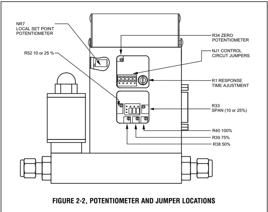
**FIGURE 2-2, POTENTIOMETER AND JUMPER LOCATIONS**
